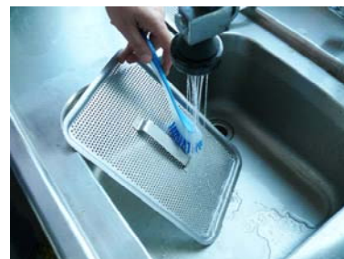
Nettoyez les filtres de la cuve
